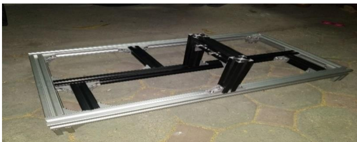
ภาพ 3.21 การประกอบโครงเครื่องจักร
